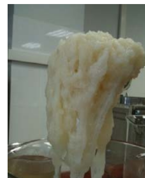
Hình 7. Polymer sau nhiều lần lọc rửa
